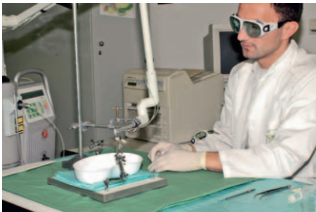
Abb. 1 Versuchsaufbau zu Messung der Präparationsgeschwindigkeit.
