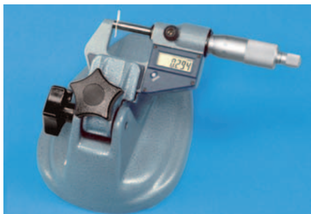
Abb. 5 und 6 Messung der Schichtdicke der Dentinscheiben li. Laserbestrahlung von beimpften Dentinscheiben.
